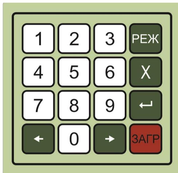
Рисунок 5 – Внешний вид декоративной плёнки клавиатуры плёночной ТФ-16-03
