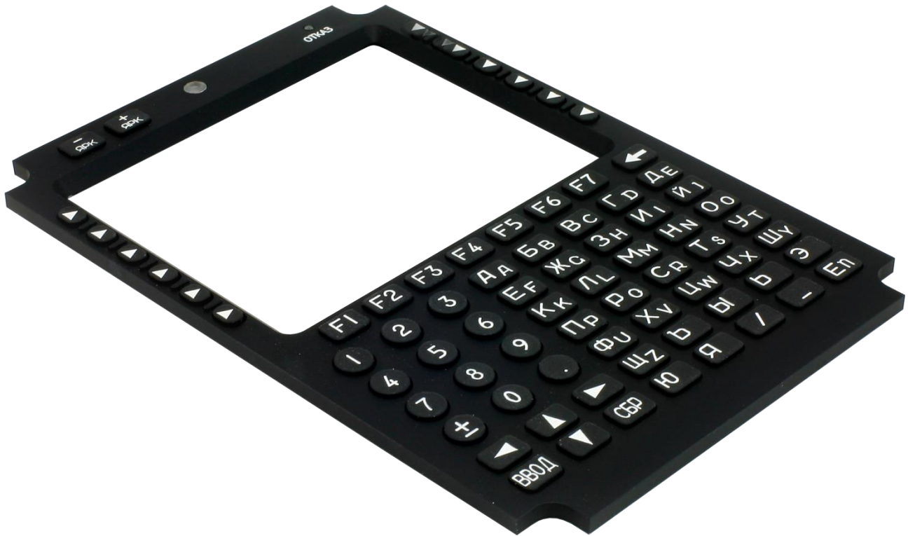
Рисунок 1. Клавиатура многофункционального пульта управления КМФПУ
