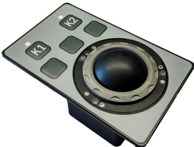
Манипулятор с кнопочной панелью, двуканальный, серый (базовый цвет)
